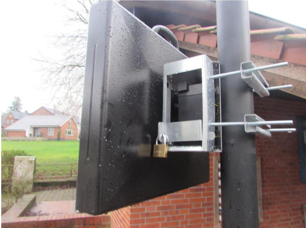
Nach anfänglichen Schwierigkeiten mit der Software funktionierte das Gerät seit dem 9. Februar fehlerfrei. Bis zum 31. März 2019 wurden insgesamt 17.813 Messungen durchgeführt. Da insgesamt vier Tage aufgrund leerer Akkus keine Messungen gemacht werden konnten, beträgt der gesamte Messzeitraum 46 Tage. Das entspricht 387 Messungen pro Tag (Fahrzeuge auf der Dorfstraße in einer Richtung), was frühere Messungen mit dem alten Messgerät bestätigt.
